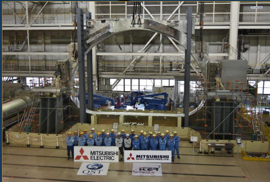
Dans les ateliers de Mitsubishi Heavy Industry, au Japon, insertion verticale du bobinage d'un aimant de champ toroïdal (TF) dans son boîtier. L'ensemble pèse plus de 300 tonnes et les tolérances d'assemblage sont de l'ordre de 0,2 millimètres.
