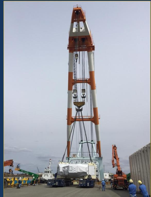
Le Japon fournit 9 (dont une rechange) des 18 bobines de champ toroïdal de la machine. Fabriquée à l'usine Mitsubishi Heavy Industries de Futami, la première d'entre elles s'apprête à prendre la mer pour être livrée sur le site d'ITER.
